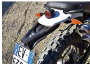
新設されたブラッシュガード。これまではオプションとしての用意があったが、全車共通品を採用。背中への泥跳ねが大幅に改善されている
