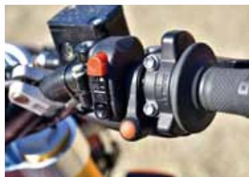
右側に新設されたのはABSキャンセルスイッチ。走行中の操作もしやすい形状に改められている
