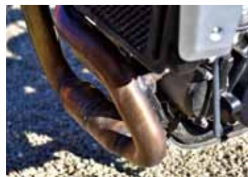
EURO-5に合わせて大型化されたキャタリティックコンバーター。位置は変わらないがはつきりわかるほどに大径化された
