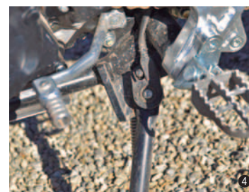
ンも変更し、幅広いライディングにも対応できるよう可動域を増やした。欧州車にありがちな弱いサイドスタンドには強化ブラケットを採用し、折れにくい構造に改良している。
