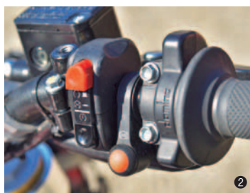
②ABSのスイッチは右側に移され、独立した構造へと変化した。これにより走行中のオン/オフも容易に操作ができるようになった。③本文中でバリトンと表現した重厚なエグジ
