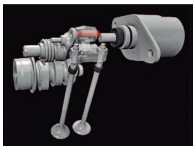
■125ccのエンジンは新たに可変バルブ機構のVVAを採用。低速カムと高速カムとをアクチュエーター（電気信号を動きに変換する装置の総称）で移動させ使い分ける構造で、厳しい規制に対応しながらも125ccらしい高回転を楽しめる単気筒に仕上がった。
