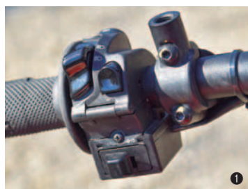
①ハンドル左側に置かれる集中スイッチはデザインが大幅に変更された。オフロードを走行する際にも水やほこりなど外乱の影響を受けにくく、耐久性に富んだ構造となっている。
